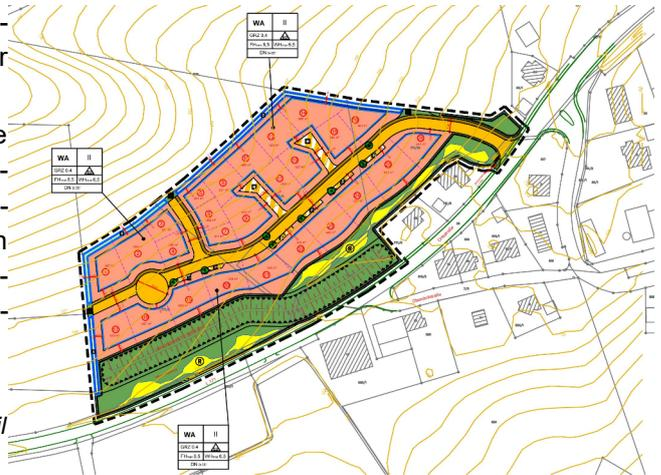
Abb. 3-1: (rechts): Ausschnitt aus dem zeichenerischen Teil des Bebauungsplanes (Entwurf - BIT-Ingenieure)
