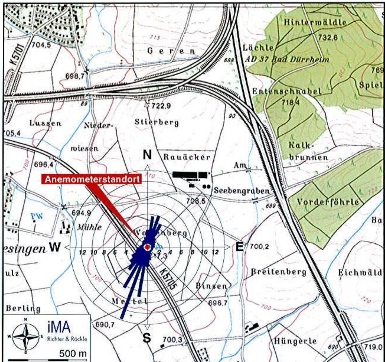
Abbildung 10-1: Lage des Anemometerstandorts (rot) und Häufigkeitsverteilung der Windrichtungen für das Kalenderjahr 2001 (blau)
