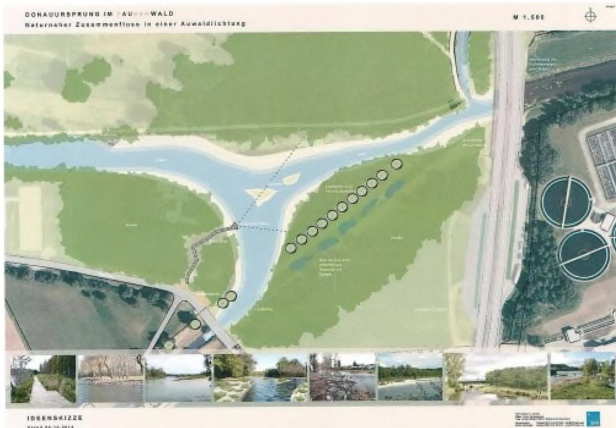
Als Idee wurde die Rückverlegung des Zusammenflusses von Brigach und Breg geboren. Der Zusammenfluss wird, etwas von der B 27 abgerückt, nach Westen verlegt. Dabei entsteht ein naturnahes „Mündungsdelta“ mit einem Auepark, der auch erlebnisorientiert gestaltet werden kann. Die naturnahe Gestaltung würde nicht nur den Zielen der Wasserrechtsrahmenrichtlinie entsprechen. Zusätzlich könnte hier auch Retentionsraum geschaffen und ein Beitrag für den Hochwasserschutz geleistet werden.
