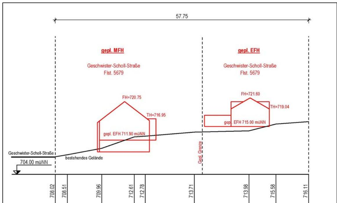
Abb.: Geländeschnitt der geplanten Bebauung (digabau GmbH)
