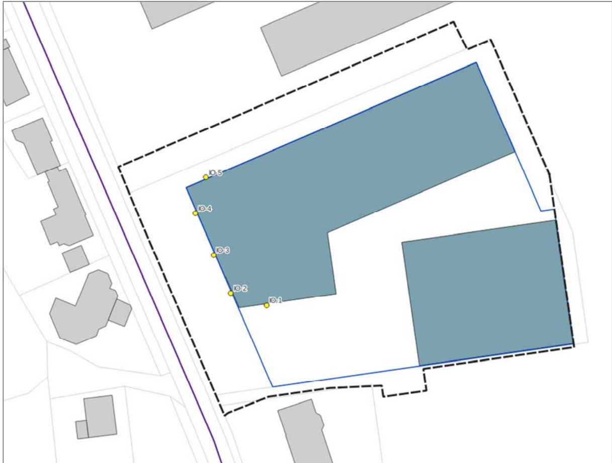
Abbildung 2: Maßgebende Immissionsorte für den Verkehrslärm an den Fassaden der Schule
