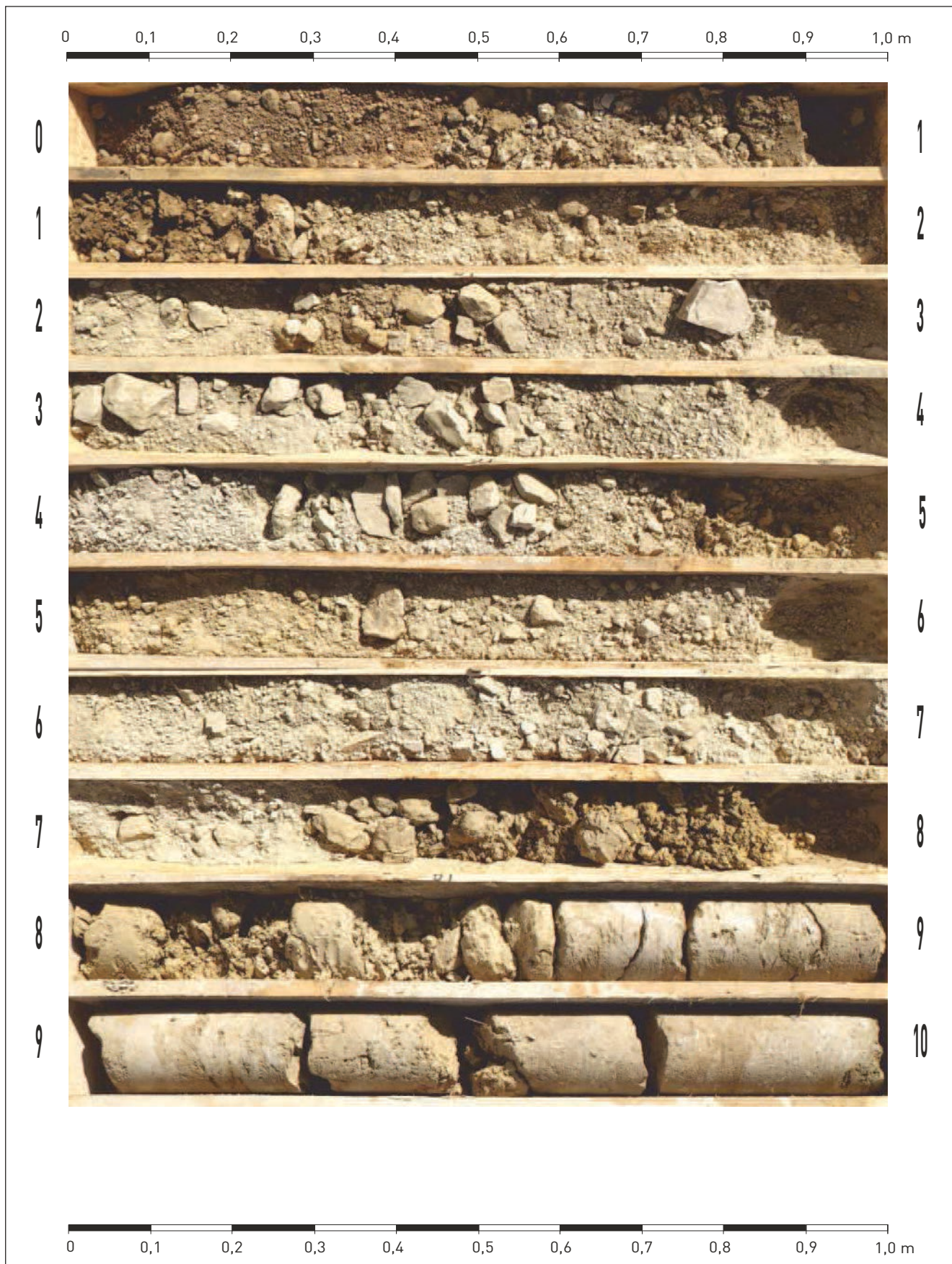
Bohrkernfotos der Kernbohrung BK 1 (0 - 10 m)
