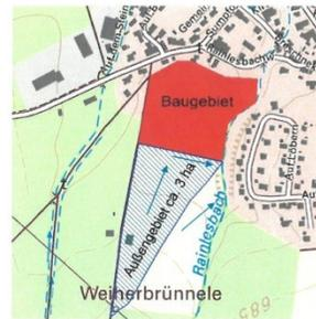
Die sonstigen Flächen des Baugebiets werden über einen neuen Kanal entwässert und das Niederschlagswasser wird unterhalb des Rainlesbachwegs in das Gewässer geleitet. Somit wird unter dem Strich vor dem Grundstück [REDACTED] weniger Niederschlagswasser in das Gewässer eingeleitet als zuvor.
